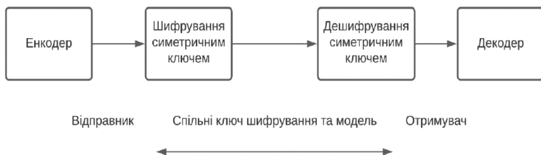
Рисунок 1 – Криптосистема з Автоенкодером та симетричним шифруванням
