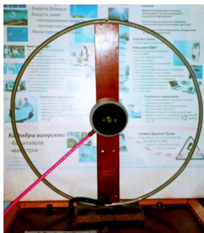
Рисунок 1 – Індукційний перетворювач для вимірювання імпульсного магнітного поля
