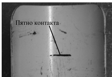
Рисунок 2 – Пятно контакта обтюрирующего пояска осколочно-фугасного снаряда
