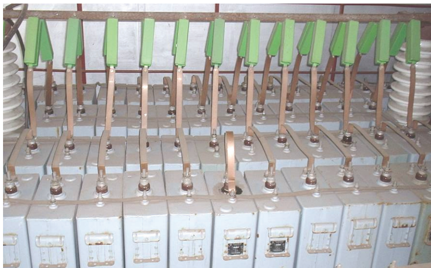
Рисунок 2 – Внешний вид фрагмента зарядно-разрядных цепей мощного ЕНЭ на 5 кВ и запасаемую электрическую энергию W_{ЕНЭ} = 567 кДж с высоковольтными импульсными конденсаторами типа ИМ-5-140 и жестко установленными на их высоковольтных выводах защитными керамическими резисторами типа ТВО-60-100 Ом [4]
