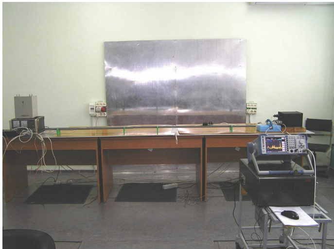
Рисунок 13 – Рабочее место при измерении эмиссии тока радиопомех
