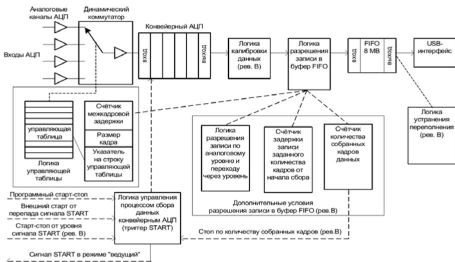
Рис. 1 – Логика управления процессом сбора данных
