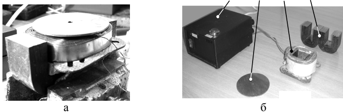
Рис. 1. Вид электромагнита физического макета ИДП в сборе (а) и его отдельных элементов (б).
