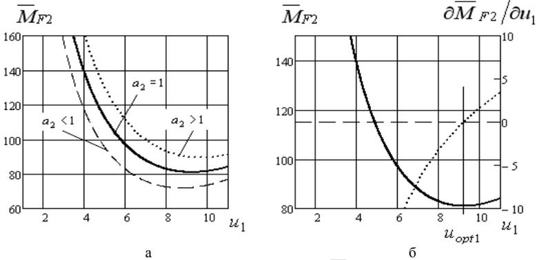
Рисунок 4 – График функции аналога массы  $\overline{M}_{F2}$ . Случай, когда  $B_2 \neq 1$ : а – общий вид функции; б – графическое решение
