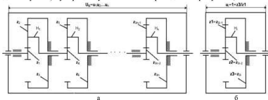
Рисунок 1 – Схема многоступенчатого планетарного механизма типа  $n \times \overline{AI}$ :
