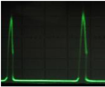
Рис. 9. Фото реалізацій з сигналами, отриманими з алюмінієвого зразка на частоті 2,5 МГц при збудженні ЄП та прийомі ПЕП
