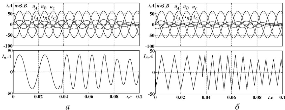
Рис. 3 – Отработка: *а* – синусоидального; *б* – треугольного, закона изменения тока задания
