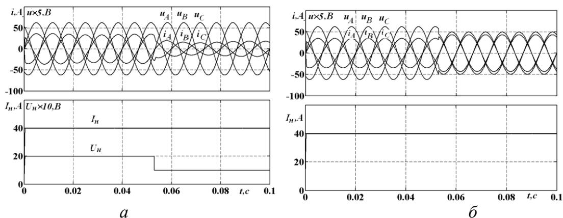
Рис. 2 – Реакция ССТ на изменение: *а* – сопротивления нагрузки; *б* – напряжения сети
