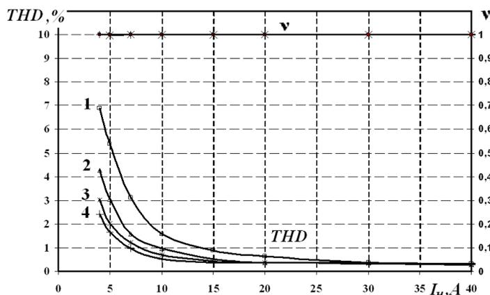
Рис. 8 – Зависимости  $THD=f(I_n)$ ,  $v=f(I_n)$  (1-  $R_n=5 \text{ Ом}$ , 2-  $R_n=10 \text{ Ом}$ , 3-  $R_n=15 \text{ Ом}$ , 4-  $R_n=20 \text{ Ом}$ )
