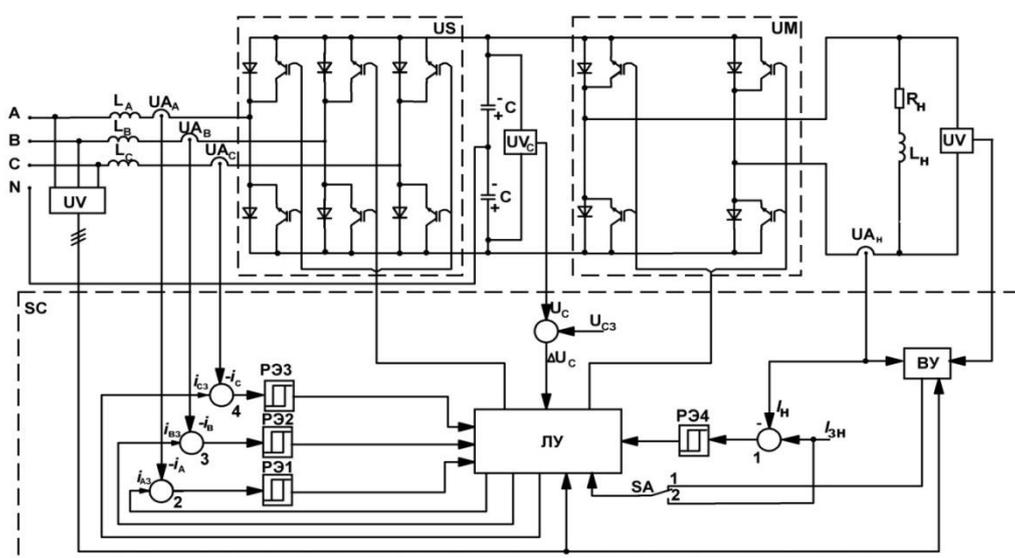
Рис. 1 – Функциональная схема системы стабилизации
