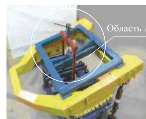
Рис. 16. Имитатор следящего нагружения механизма на макете
