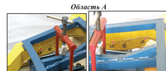
Рис. 16. Имитатор следящего нагружения механизма на макете
