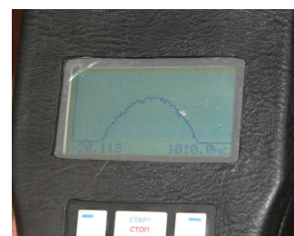
Рис. 2. Возбуждение и фиксация колебаний
