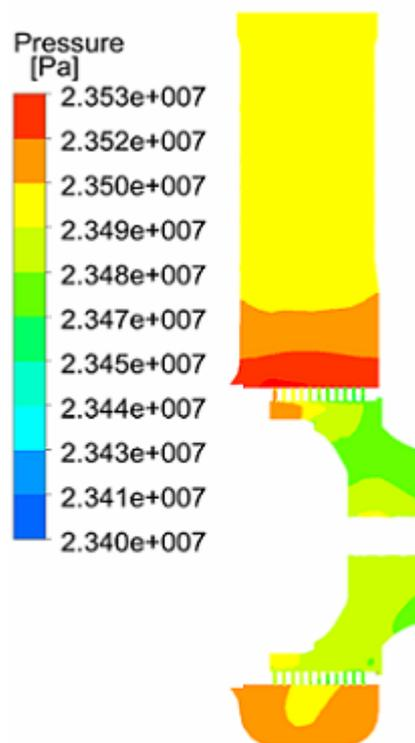
Рис. 8 – Давлення пара в сеченні X
