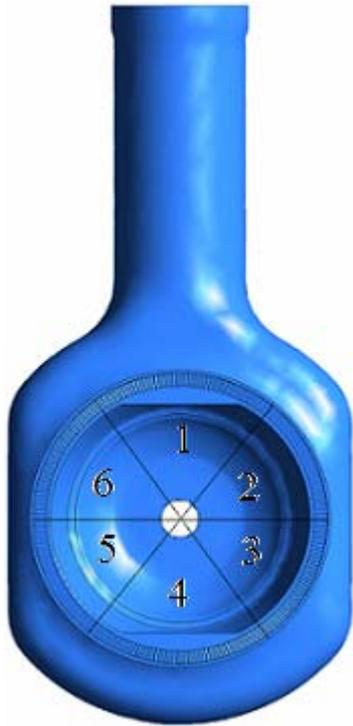
Рис. 2 – Камера сита и входной патрубков
