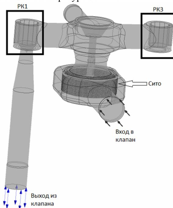
Рис. 1 – Пространственная схема проточной части регулирующего клапана
