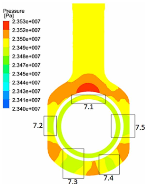
Рис. 7 – Давлення пара в сеченні Z
