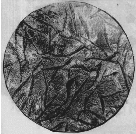
Рис. 5 – Микроструктура булатной стали. Содержание углерода 6,0%. 250 x
