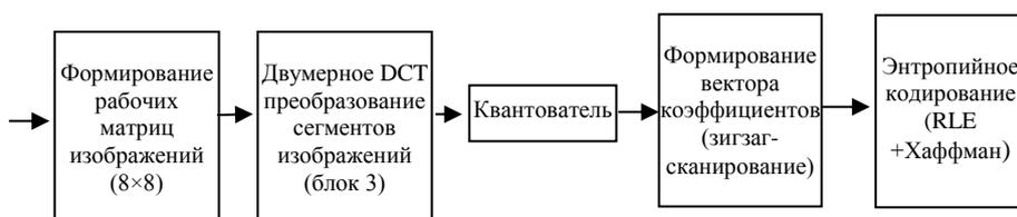
Рис. 2. Схема кодирования изображений в терминах JPEG-технологий
