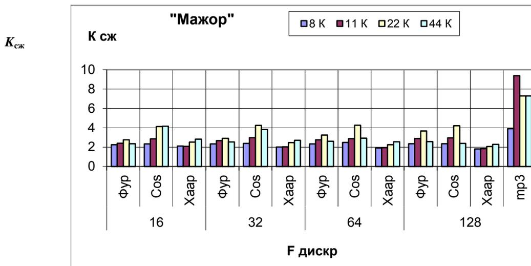
Рис. 4. Зависимость  $K_{сж}$  от частоты дискретизации, длины фрейма и анализируемого преобразования музыкальной композиции "Мажор"
