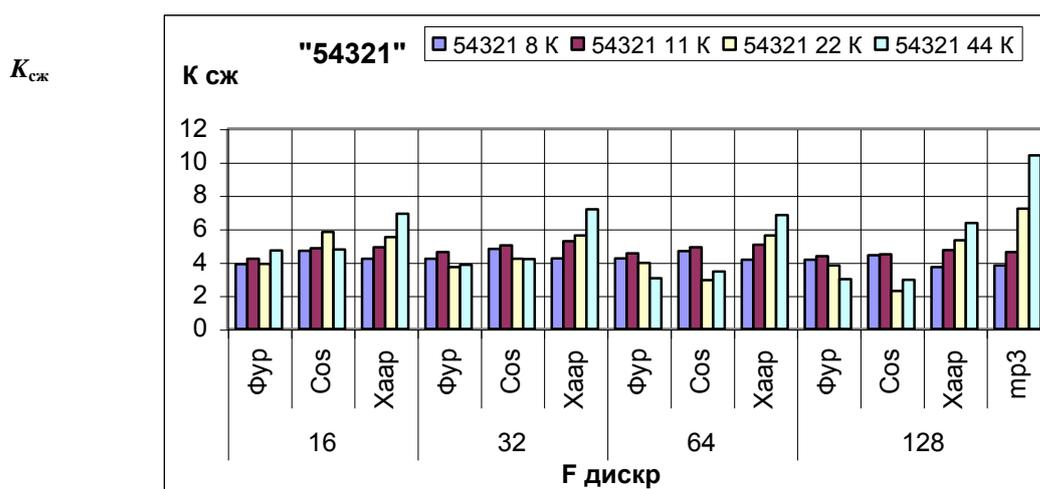
Рис. 3. Зависимость  $K_{сж}$  от частоты дискретизации, длины фрейма и анализируемого преобразования последовательности слов "пять, четыре, три, два, один"
