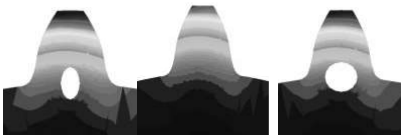
Рис. 4. Эпюры распределения упругих перемещений на различных КЭ моделях с модификацией и без нее
