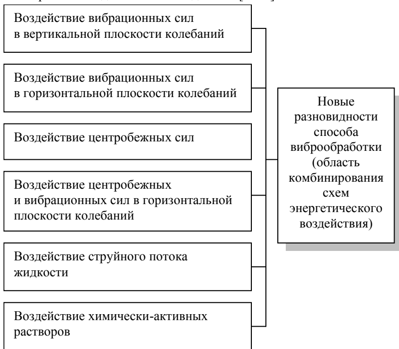
Рисунок 1 – Схемы энергетического воздействия на рабочую среду и обрабатываемые детали в процессе отделочно-зачистной обработки
