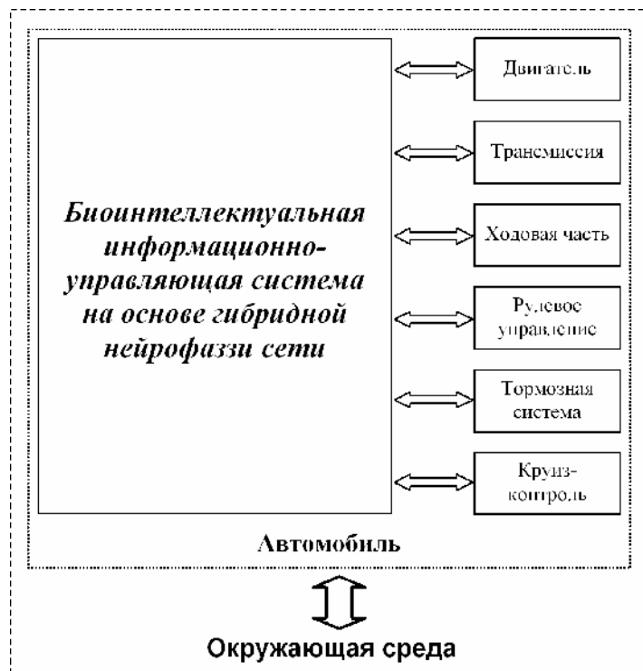
Рис. 2. Пример структурной схемы биоинтеллектуального автомобиля с информационно-управляющей системой на основе гибридной нейрофаззи сети
