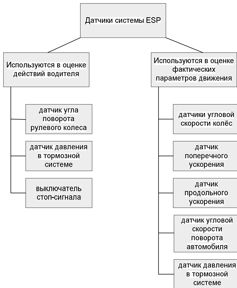
Рисунок 1 - Датчики системы ESP
