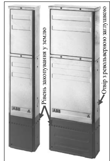
Рис. 47. Зовнішній вигляд шаф CDCM X20 (X = 0 – без шин; 4 – з шинами на 400 A) та CDCM X40 (X = 0; 4 та 6 – з шинами на 630 A)
