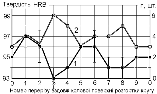
Рисунок 6 – Показники твердості ріжучого шару круга (1), на якому провадилися дослідження по вивченню хвильової формозміни ріжучої поверхні круга 12A2-45°150x10x3x32 - КР 100/80 - ПК-03 100%, співставлені з кількістю (2) положень (n) западини хвилі при її русі вздовж ріжучої поверхні, що припадають на визначені точки перерізів вздовж розгортки круга (маса зшліфованої сталі Р6М5Ф3 складала 864 г.).
