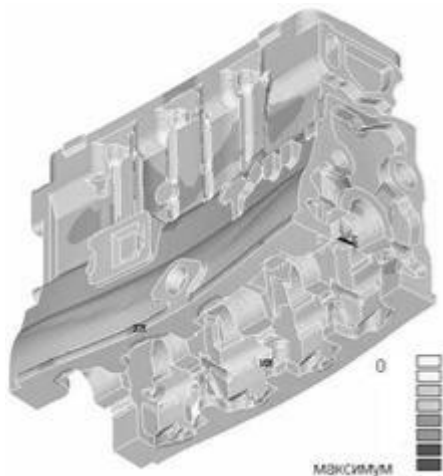
Рис. 1 - Распределение полей коэффициентов чувствительностей первой собственной частоты к изменению приведенного модуля упругости на поверхности отливки блок-картера дизеля.
