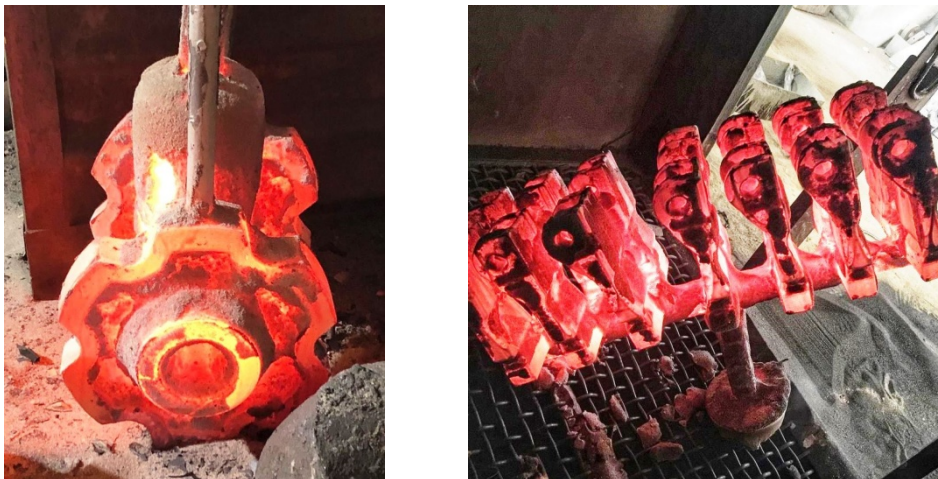
Рис. 2 – Виливки, які при ЛГМ в стані світіння видалено з сипкого піску форми
