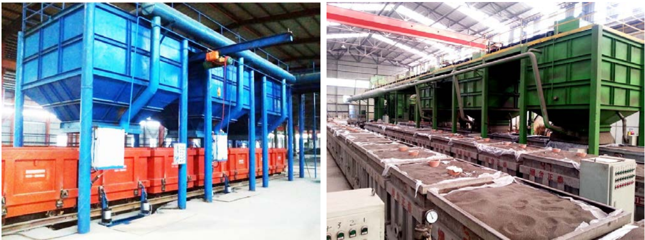
Рис. 1 – Конвеєрні лінії ЛГМ з трьома бункерами для формовки сухим піском
