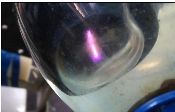
Рисунок 1 – Фото разряда в газовом пузыре внутри жидкости
