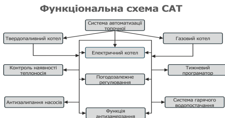
Рисунок 1 – Функціональна схема системи автоматизації топочної
