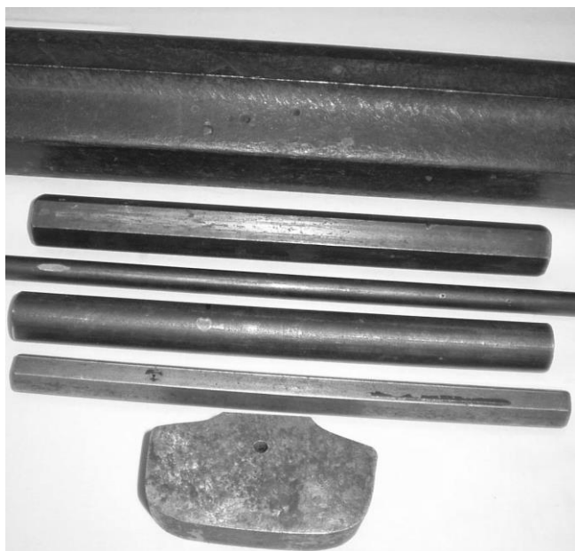
Рис. Образцы для настройки и проверки ЭМА дефектоскопов
