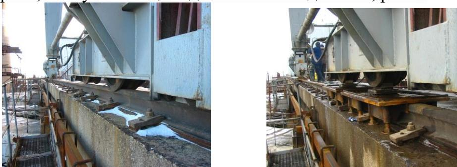
Рис. 3 Определение фактического угла установки ходовых колес
