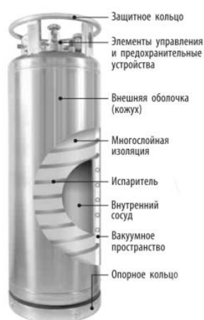
Принципиальная схема криогенного цилиндра
