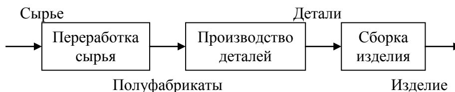
Рисунок 1. Модель процесса «Изготовление изделия»
