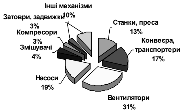
Рис. 3. Структура попиту на асинхронні двигуни за механізмами використанням
