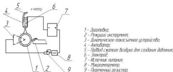
Рисунок – Принципиальная схема установки для комбинированной электрохимической обработки
